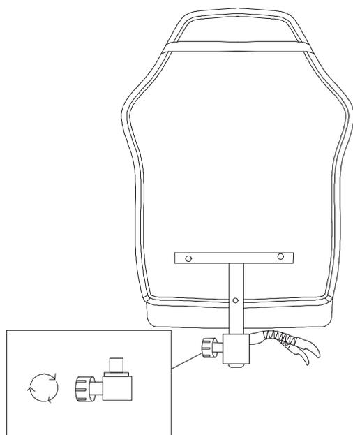
Вставьте спинку с деталью «M» в деталь «D», которую установили на сиденье в шаге 1, и закрутите фиксатор до конца.
